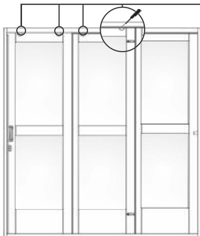
Retire os parafusos dos suportes com roldanas, utilizando a chave adequada para não danificar o produto.
